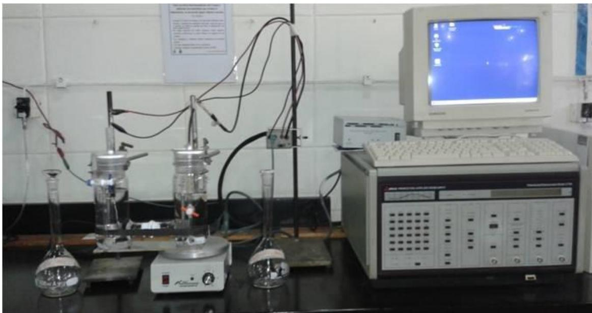
**Figura 1. Celda electroquímica con sistema de agitación conectada al equipo.**
