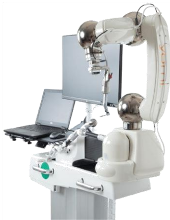
Figura 6. Robots guía Yomi dental autónomo para cirugía
