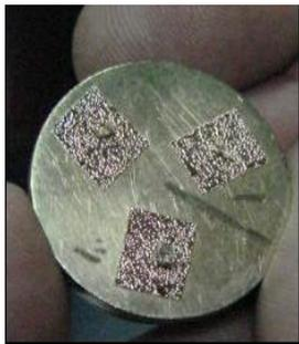
**Figura 2. Placa con las muestras recubiertas en oro.**
