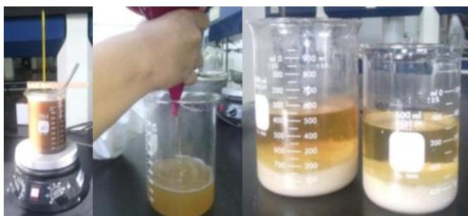
**Fig. 3:** Hidrólisis ácida para la extracción de pectina.
