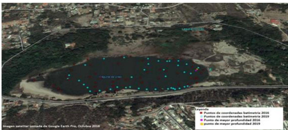
FIGURA 12. Puntos de coordenadas para la determinación de la batimetría. Nótese que los puntos de mayor profundidad se encuentran hacia el extremo Este. Fuente: Google Earth, (2018). Fuente: Elaboración propia.
