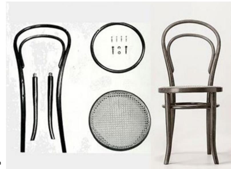
[Fig. 10] Despiece de la Silla N° 14 del diseñador Michael Thonet, desarrollada entre los años 1859-1960 con material madera de haya curvada, siendo el resultado de la patente registrada en el año de 1841 para el doblado en caliente de la madera.
