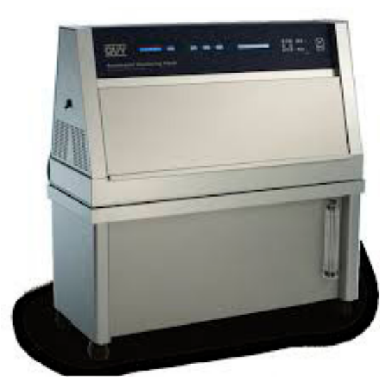
FIGURA 1. Equipo de envejecimiento acelerado QUV/ Basiccon tubos fluorescentes UVB 313 con un pico de 313 nm.
