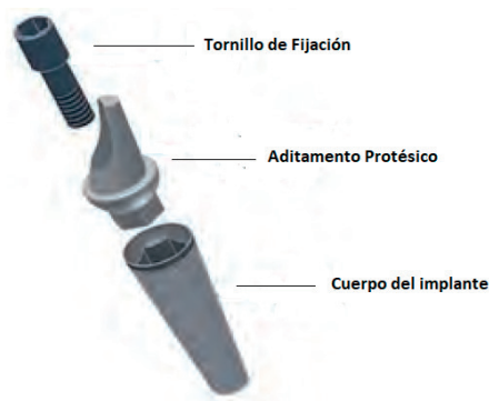
FIGURA 1. Componentes de un sistema de implante dental: cuerpo del implante, aditamento protésico y tornillo de fijación (Uzcátegui et al. 2018).
