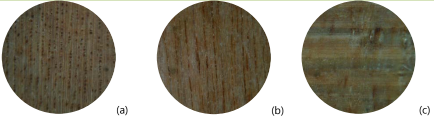
Figura 45: Brunellia integrifolia . Vista macroscópica: (a) Sección transversal. (b) Sección tangencial. (c) Sección radial.
