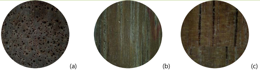
Figura 203: Mouriri huberi . Vista macroscópica. (a) Sección transversal. (b) Sección tangencial. (c) Sección radial.
