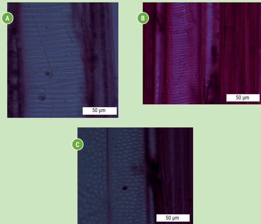
**[FIGURA 3]** Punteaduras intervasculares escalariformes en: **[A]** *Clusia* sp., **[B]** *Piper obliquum*. Punteaduras intervasculares opuestas en *Mahurea exstipulata*. (Barra = 50 µm).
