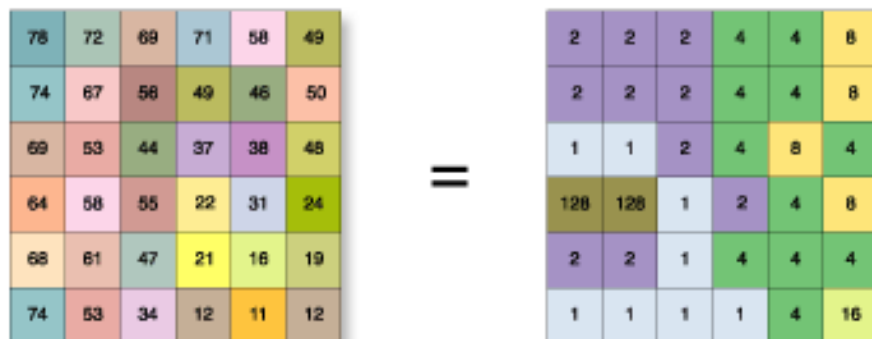
FIGURA 3. Transición de ráster de elevación a ráster de dirección de flujo. Fuente: ESRI, 2014
