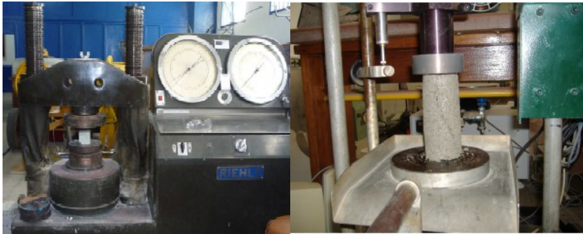
FIGURA 2. Ensayos de compresión inconfiada de rocas y suelos del sector Mesa de Los Indios
