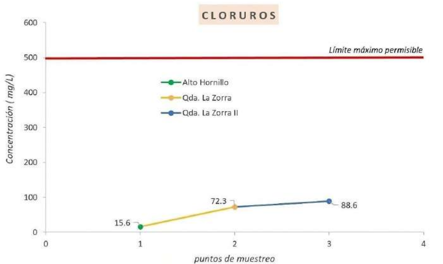
FIGURA 4. Contenido de cloruros. Fuente: elaboración
