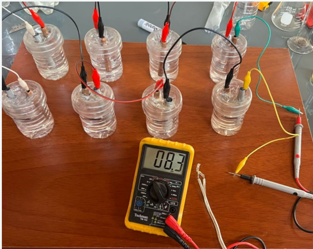
Figura 3.- Vistas de la celda y batería de 8 celdas de Cu/Al usando como medio electrolítico NaOH al 0,128 %.
