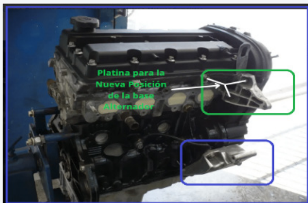
Figura 3. Platina para la nueva posición de la base del Alternador.
